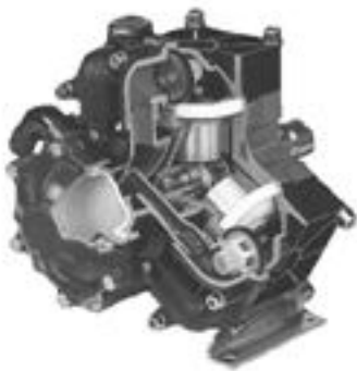
Рис. 19. Диафрагменно-поршневой насос Imovilli Rompe (Италия).
