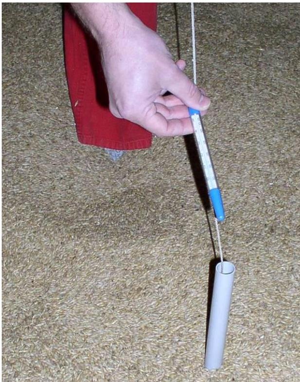
*Иллюстрация 1.2.2: Термометр зерна (фотография: Ю. Бое)*
