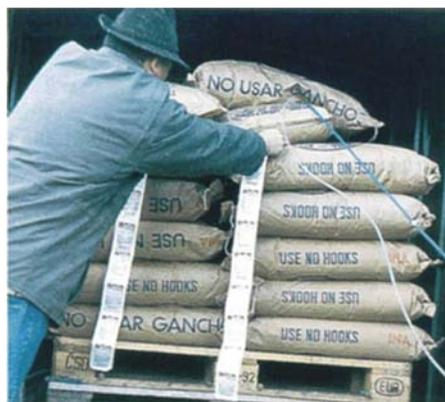
*Иллюстрация 13.1.1: Применение фумигационных лент в контейнере, используемом в качестве фумигационной камеры (фотография: Detia Degesch)*
