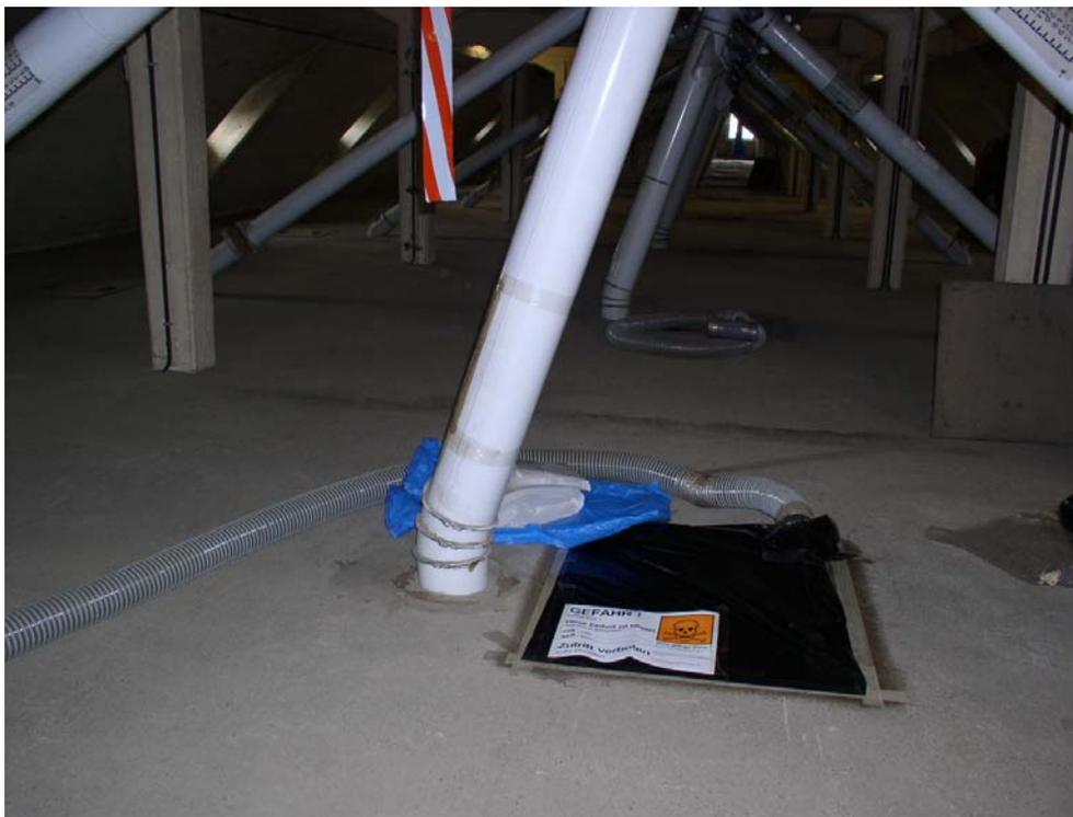
*Иллюстрация 10.3.1: Бункер, подготовленный к фумигации с системой рециркуляции (фотография: Ю.Бое)*
