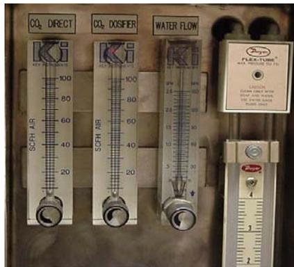
Иллюстрация 6.1.2: Измерители потока генератора газа фосфина (фотография: Detia Degesch)
