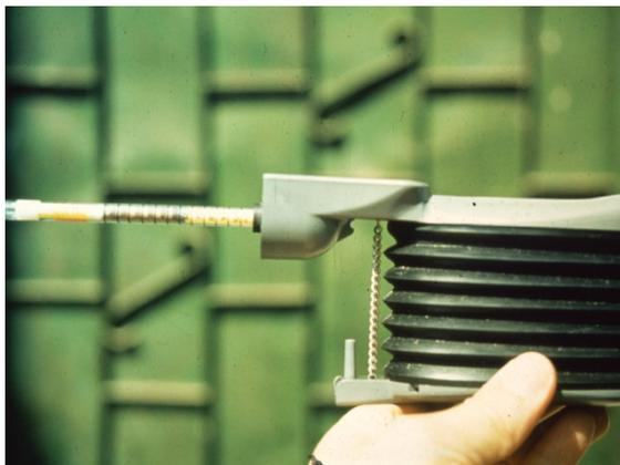
Изображение 4.2.8: Газовый насос с реакционной трубой (фотография: GTZ)
