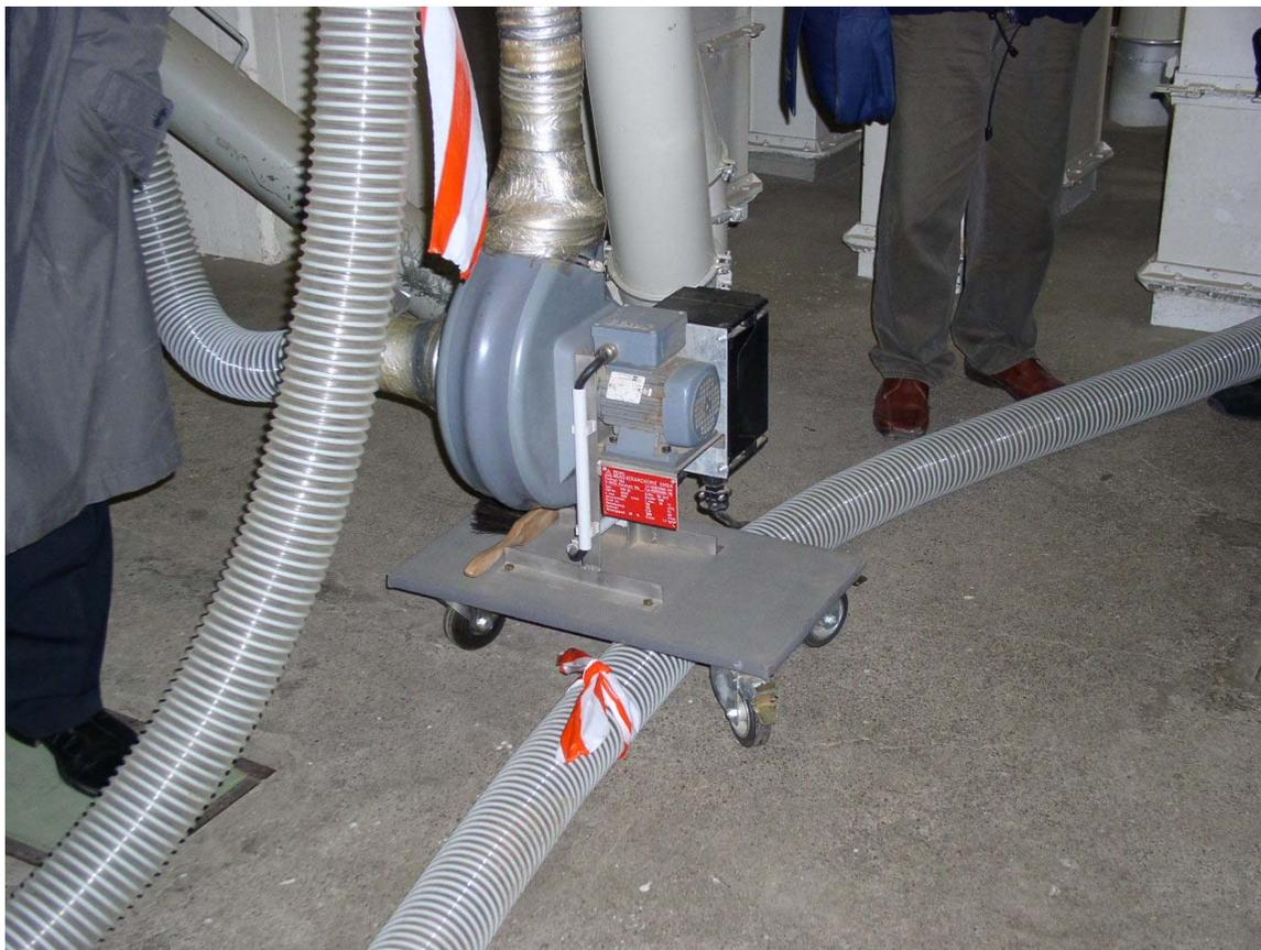
*Иллюстрация 10.1.1: Воздухозаборник, используемый в системе рециркуляции (фотография: Detia Degesch)*
