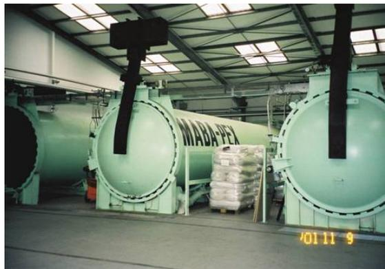
*Иллюстрация. 15.1.1: Камеры высокого давления для дезинфекции продовольственной продукции при помощи углекислого газа и высокого давления в Измире, Турция (фотография: С. Наварро)*
