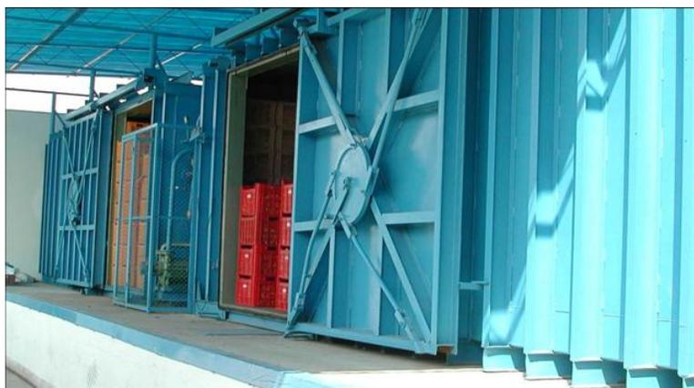
Рис. 14.2.1: Твердые вакуумные камеры для обработки фумигантами продовольственных продуктов. (фотография: С.Наварро)
