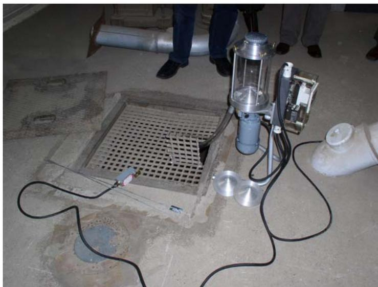
*Иллюстрация 9.2.1: Раздаточный аппарат, установленный над силосом (фотография: Detia Degesch)*
