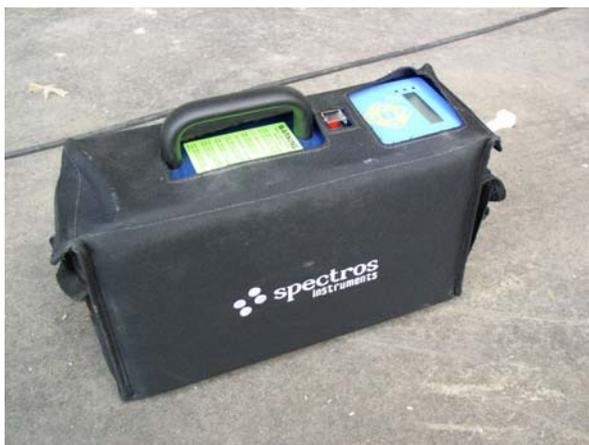
Это устройство основывается на технологии инфракрасного излучения и с его помощью можно измерить газовые концентрации в диапазоне 0 - 1000 ppm. Он выполняет ту же функцию, что и Интерскан.
