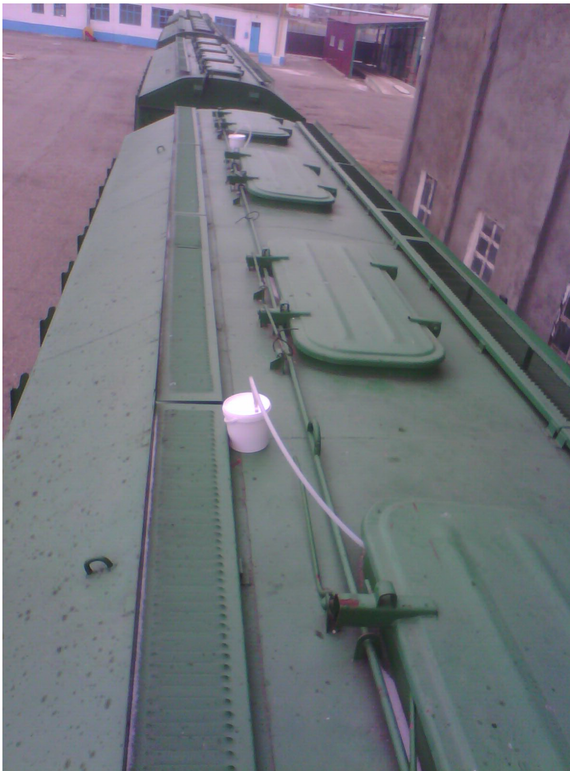
Рис.2 Подача газа фосфин из генератора СГФ-М2, через люки №1 и №3 в зерновую массу вагона-зерновоза.
