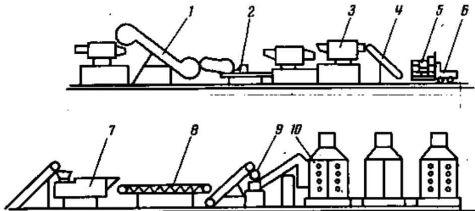
Рис. 86. Схема производства сушек моркови:
