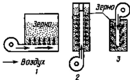
Рис. 46. Схемы движения воздуха в зерновой массе при активном вентилировании в хранилищах и на площадках:
