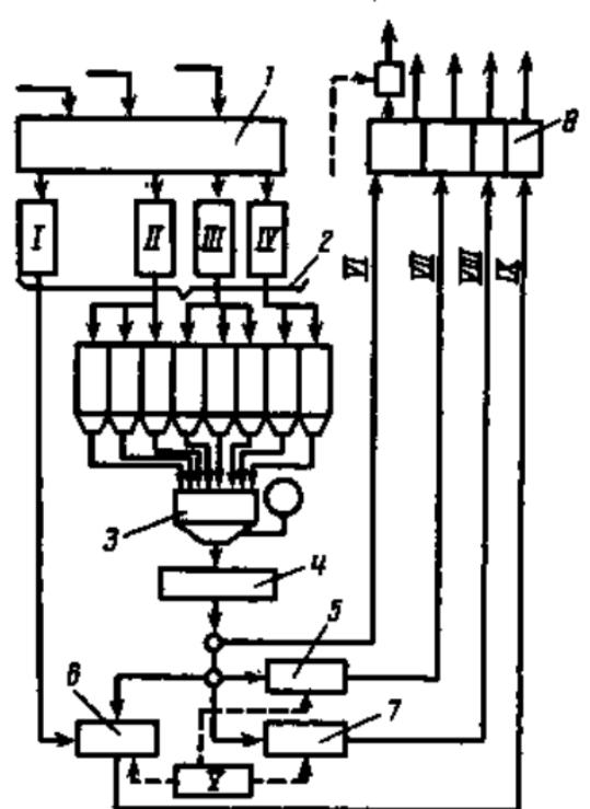
Рис. 92. Схема производства комби-кормов:
