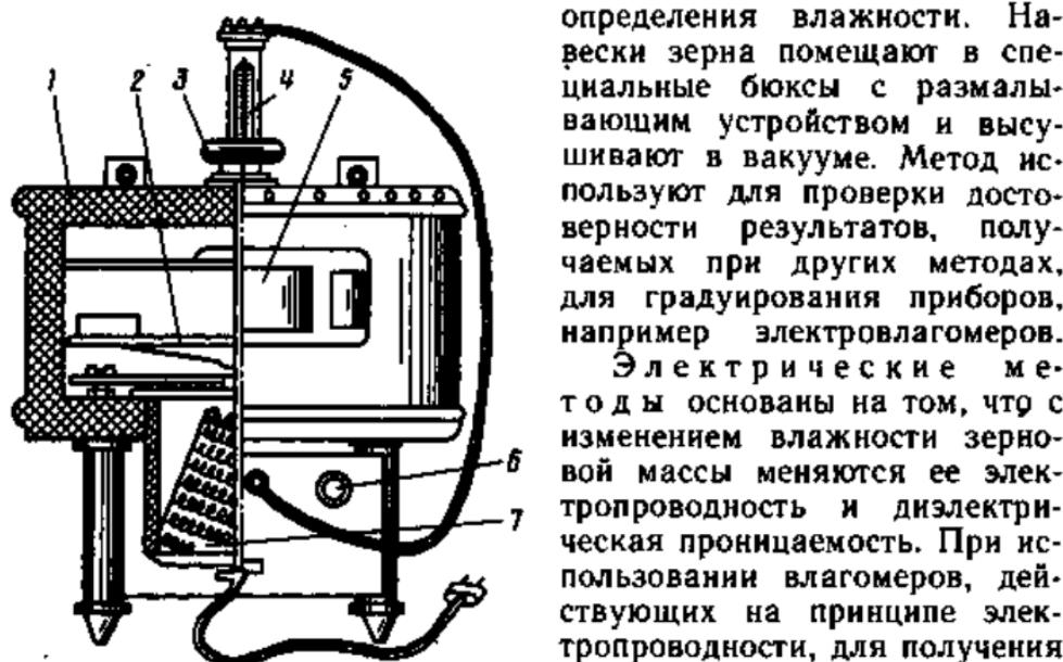
Рис. 5. Сушильный шкаф СЭШ-3М:
