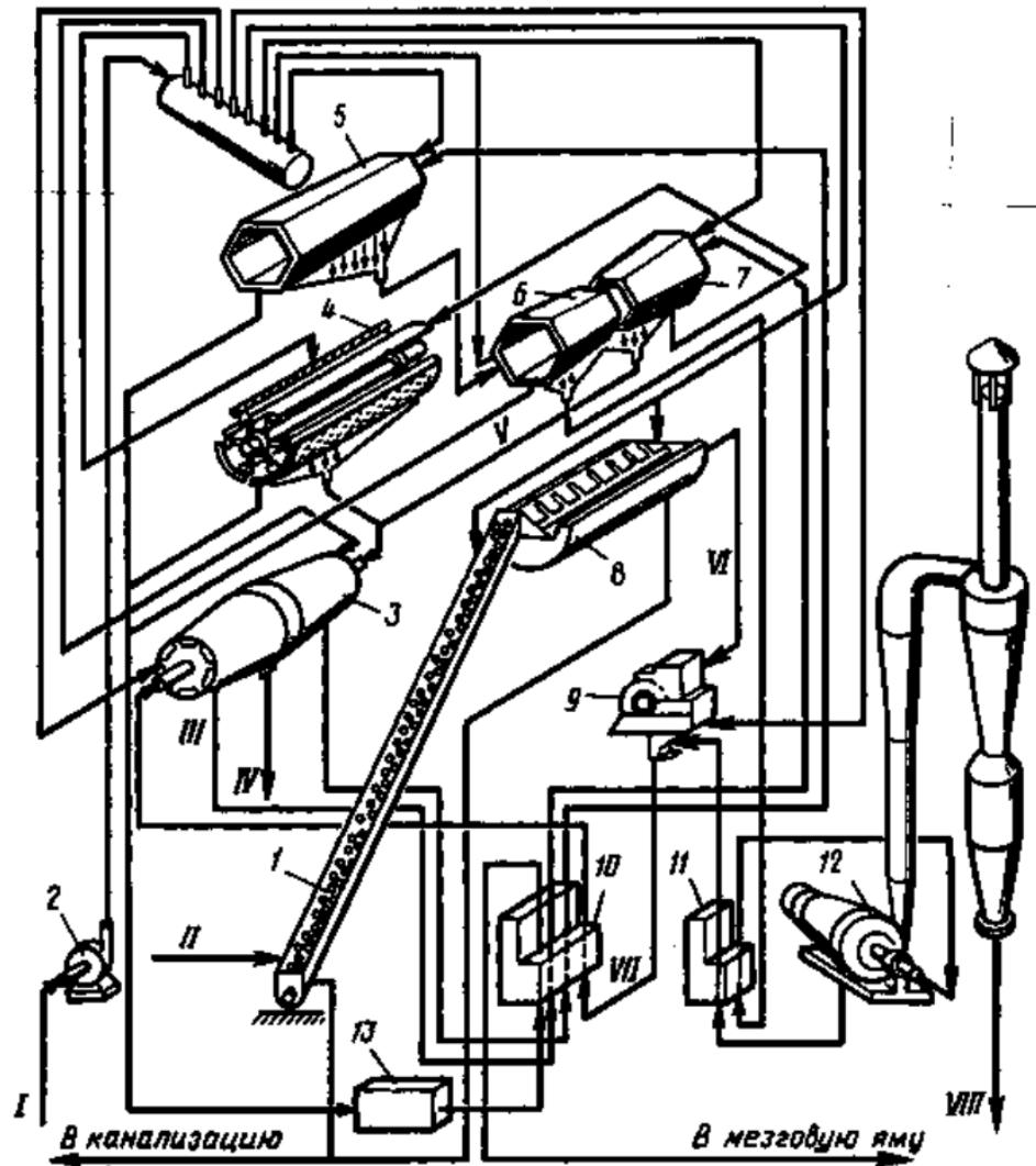
Рис. 87. Схема картофелеперерабатывающего агрегата АПЧ-25 С:
