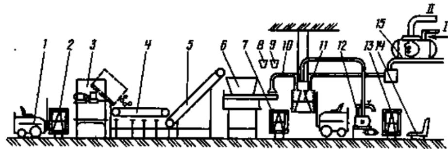
Рис. 83. Механизированная линия квашения капусты в контейнерах ЕС-200:
