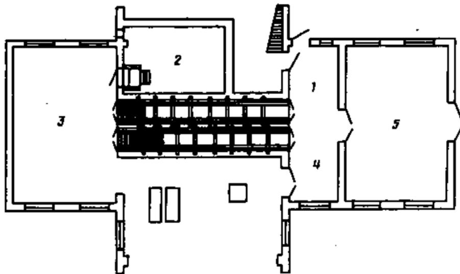
Рис. 90. Двухкамерная паровая сушилка трести:
