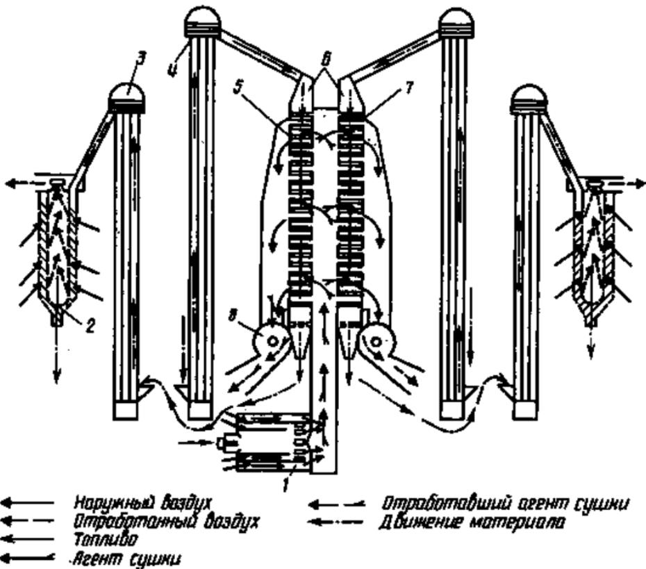
Рис. 41. Технологическая схема зерносушнялки СЗШ-16 при параллельной работе шахт:
