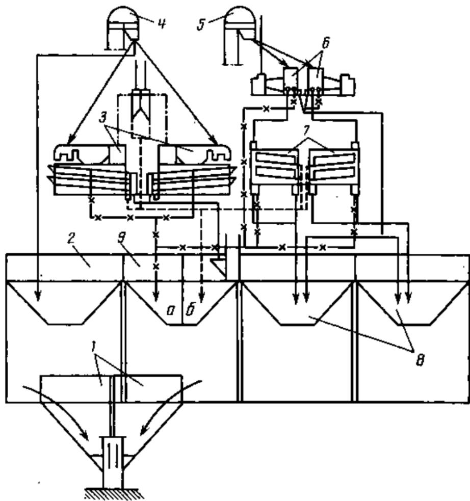
Рис. 45. Зерноочистительный агрегат ЗАВ-40:
