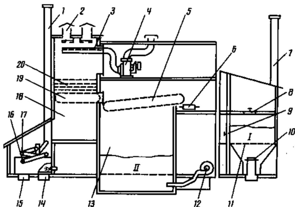
Рис. 91. Установка для сушки, кондиционирования и сульфитации хмеля:
