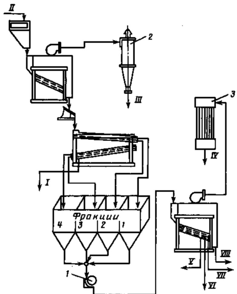
Рис. 58. Схема переработки гречихи на крупорушке сельскохозяйственного типа:
