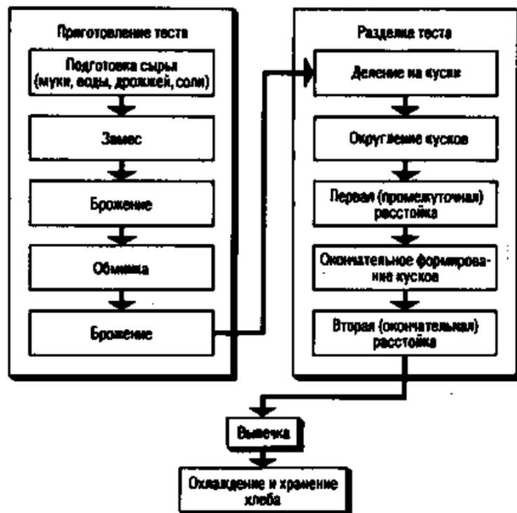
Рис. 59. Схема технологического процесса производства пшеничного хлеба без опары способом.
