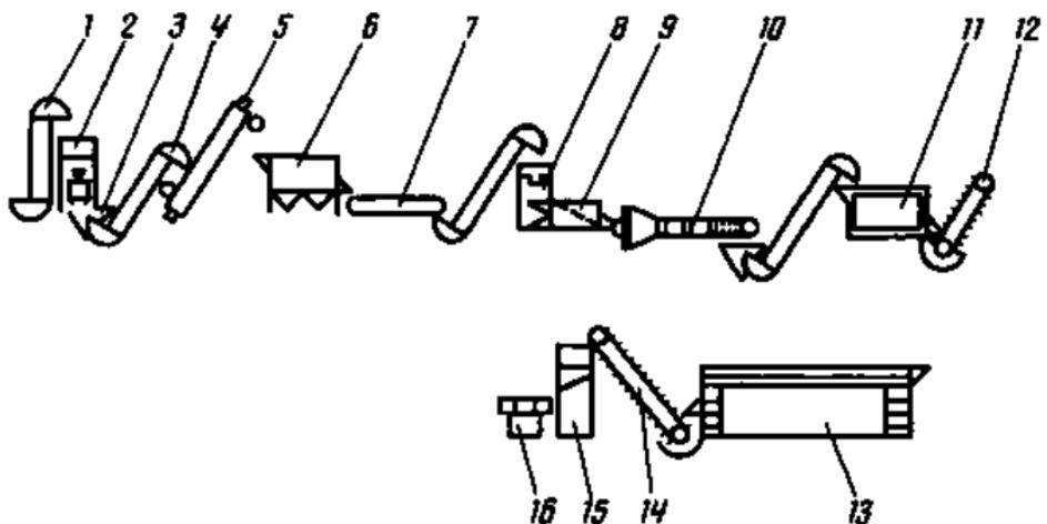
Рис. 85. Технологическая линия производства замороженного гарнирного картофеля:
