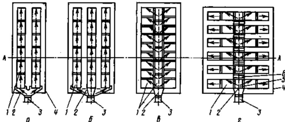
Рис. 48. Воздухораспределительные решетки (каналы) напольно-переносных установок:
