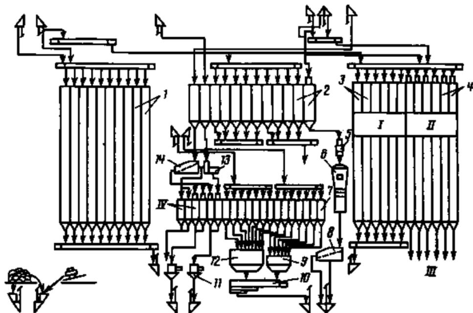
Рис. 93. Технологическая схема межхозяйственного комбикормового завода:
