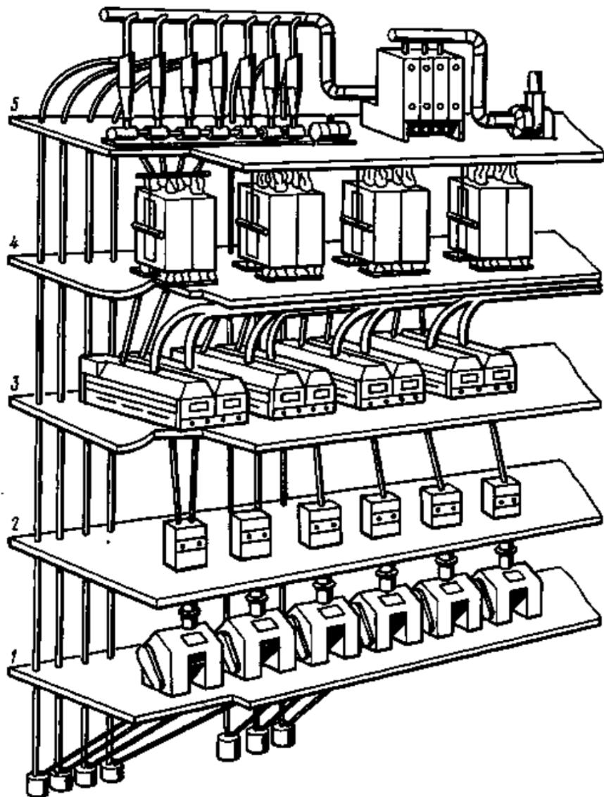
Рис. 56. Размещение машин в размольном отделении мукомольного завода:
