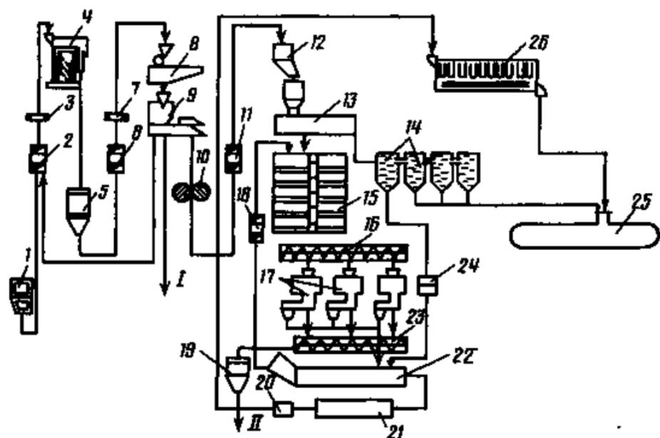
Рис. 61. Технологическая схема производства растительного масла прессовым способом:
