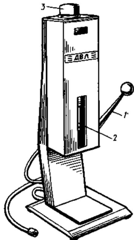
Рис. 12. Дозатор воды ДВЛ-3:
