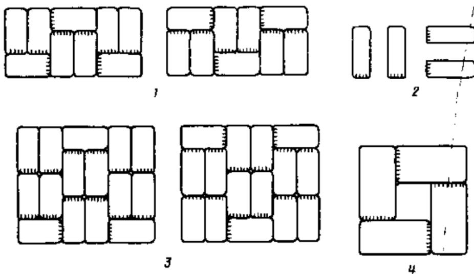
Рис. 53. Схема укладки мешков с семенами в штабеля:
