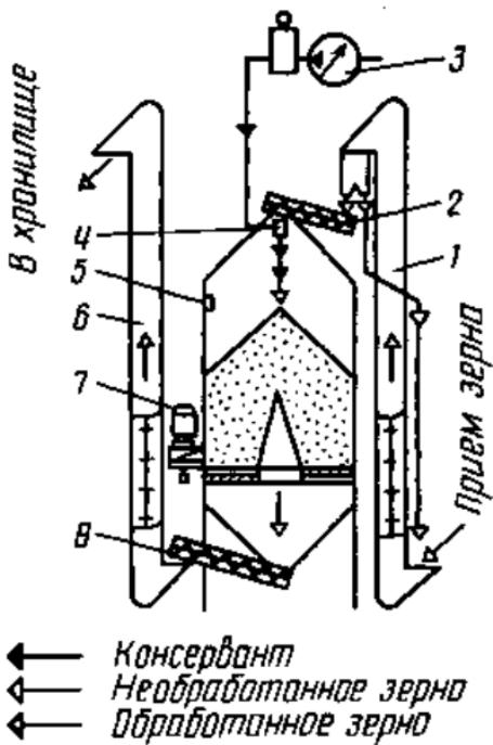
Рис. 52. Технологическая схема обработки зерна консервантами:
