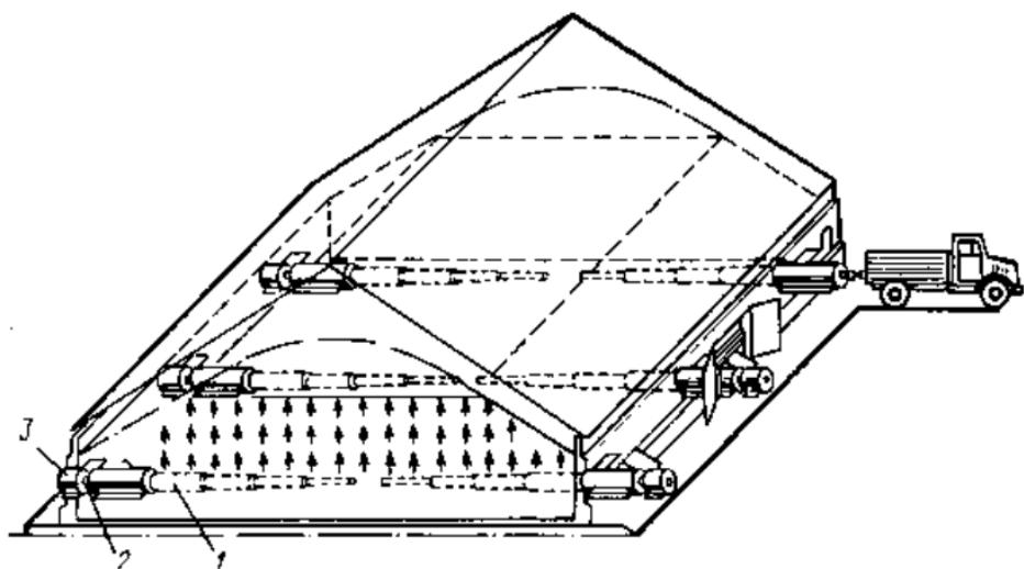
Рис. 49. Телескопические установки ТВУ-2, размещенные в складе:
