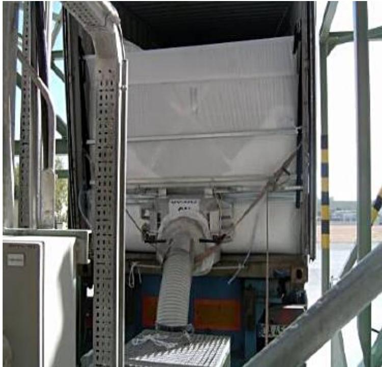
•**Вакуумная выгрузка:** Контейнер устанавливается на наклонную платформу. Угол наклона контейнера должен составлять 30-45°. Выгрузочная труба устанавливается в контейнер. Продукт засасывается под действием вакуума. При использовании мобильной установки выгрузка может происходить без наклона контейнера.
