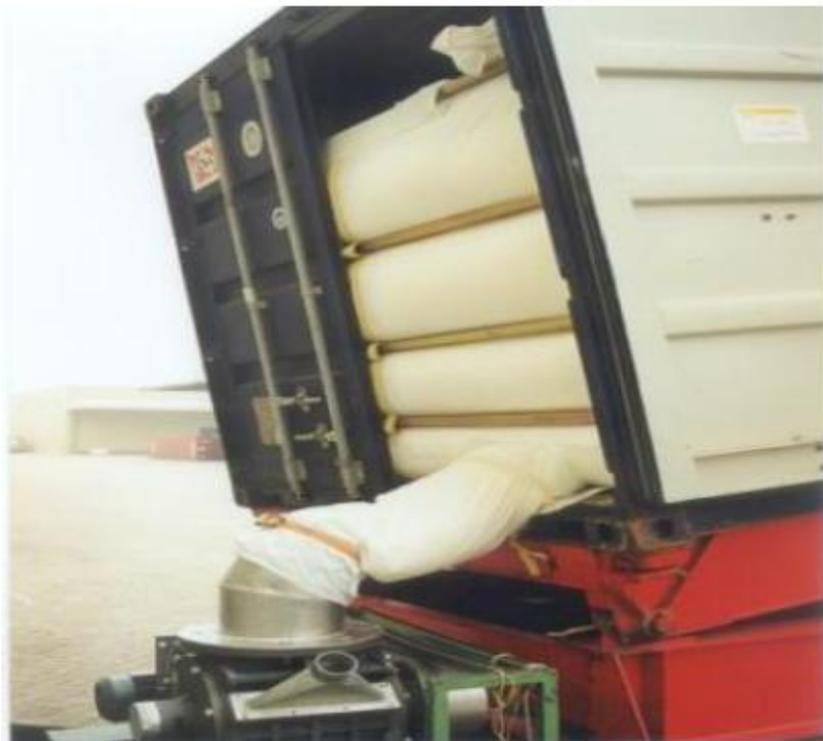
• **Пневмовыгрузка:** Контейнер наклоняется на угол 30-45 градусов. Под действием силы тяжести продукт через выгрузочный рукав поступает в роторный питатель, подключенный к пневмотранспорту. Далее пневмотранспортом продукт перемещается в емкость для хранения.
